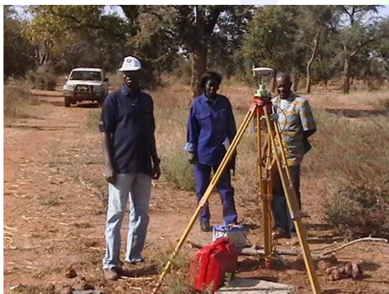
Mise en place de la station GPS de référence
