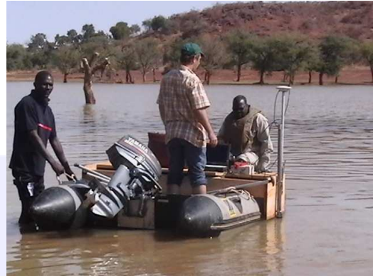
Navire de sondage bathymétrique
